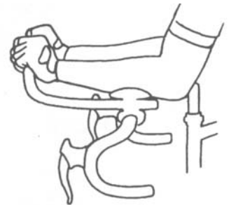
FIGURA 18.6 – Mãos no centro do guidão: para rodar a velocidade reduzida ou realizar uma subida permanecendo sentado.
