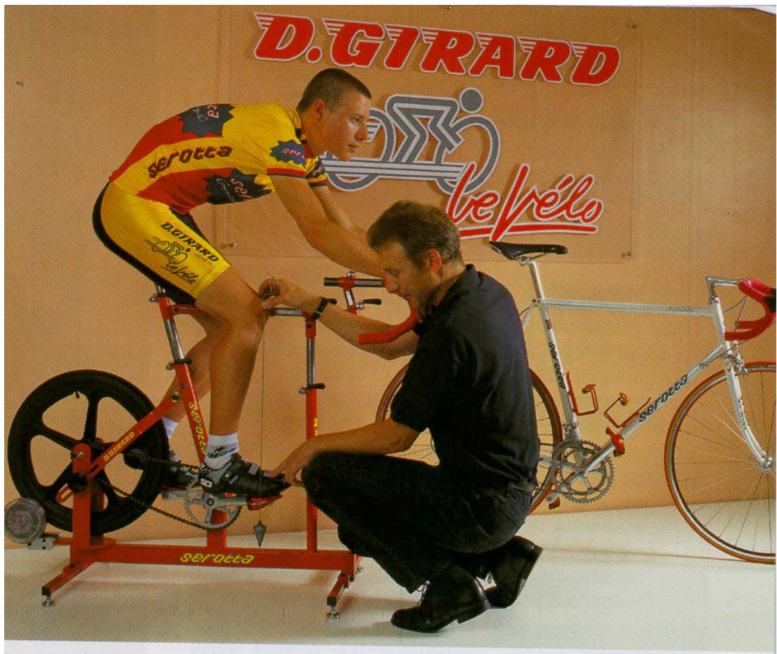
FIGURA 2.8 – Bike Fit aparelho para dimensionar a bicicleta de acordo com as dimensões do usuário (Prospecto de divulgação)
