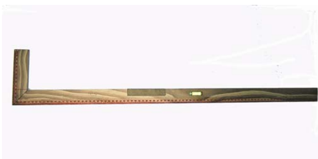
Figura 9.23 – Régua para medir altura do selim em relação ao guidão (desenvolvida pela autora do projeto).
