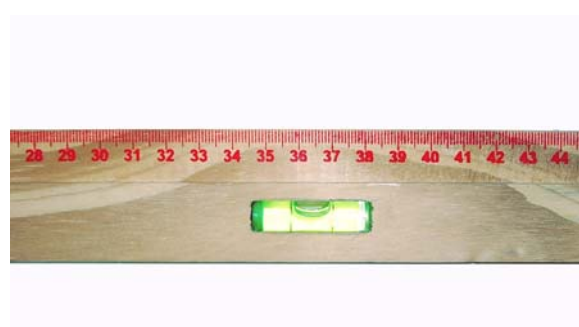
Figura 9.24 – Detalhe do nível da régua.
